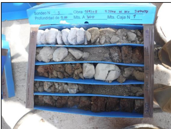
Foto 23: Sondeig S-5, caixa de 0 a 3 metres
