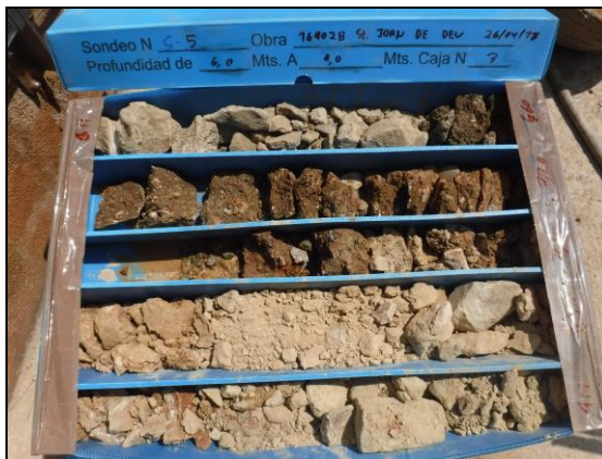
Foto 25: Sondeig S-5, caixa de 6 a 9 metres.
