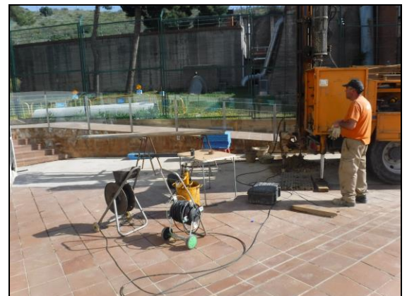
Foto 28: Assaig presiomètric
